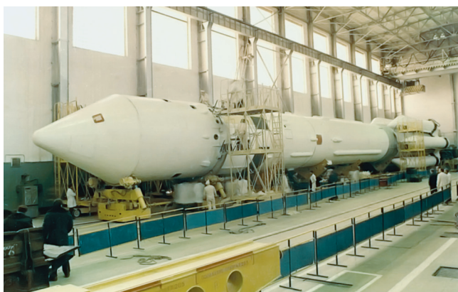
Станция «Алмаз-Т» состыкована с ракетой-носителем УР-500К на космодроме Байконур
