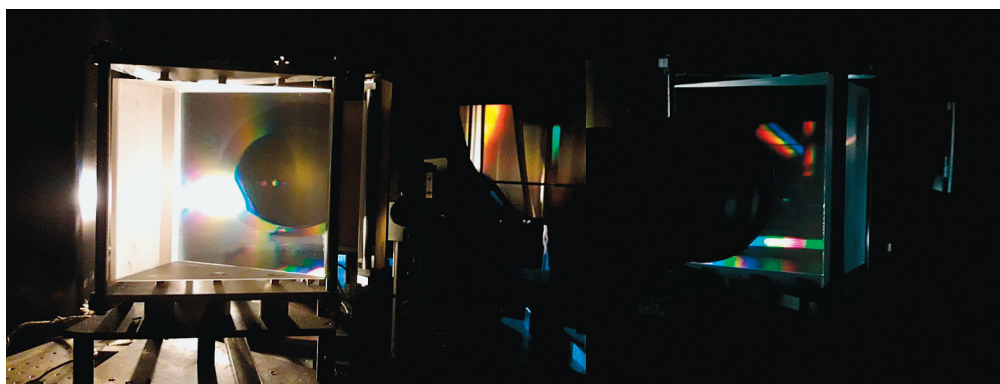
Диспергирующая оптика спектрографа высокого спектрального разрешения САО РАН для исследования экзопланет. Слева – кросс-дисперсионная призма с крупногабаритной дифракционной решеткой эшелле. Справа – кросс-дисперсионная призма с другого ракурса. Фотография из личного архива Г.Г. Валявина
